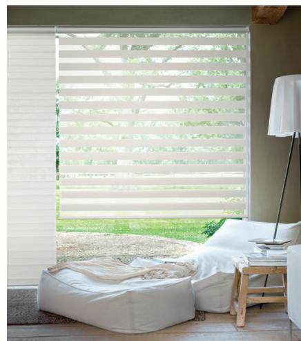
Le store « alternance » est constitué d'une toile alternant bandes horizontales ajourées translucides et imprimées, d'un tube entraînant la toile, de supports de fixation, d'une chaîne, d'un profil arrière blanc et d'une barre de lestage en partie basse.
