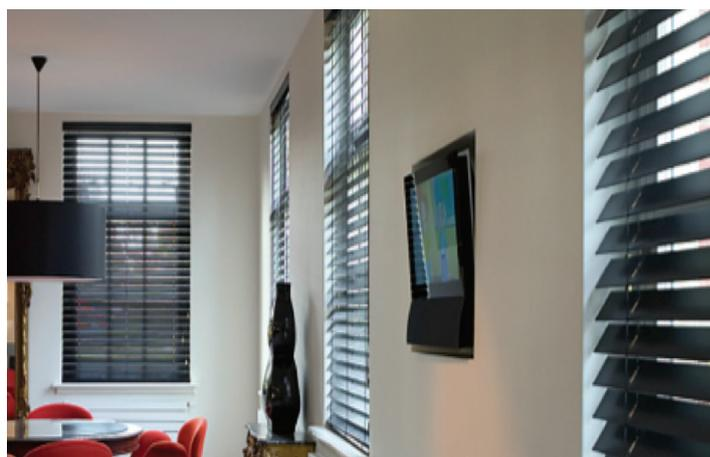
Les stores vénitiens bois cordon sont composés d'un boîtier acier, d'un tablier de lames et d'une barre finale en bois. Une cantonnière, avec ou sans retour, fixée sur le boîtier à l'aide d'aimants assure une parfaite finition du produit. Le tablier de lames est proposé soit en échelle filiforme, soit en galon textile.
